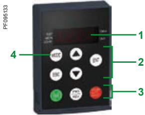
Zdalny terminal tekstowy z otwartą osłoną
