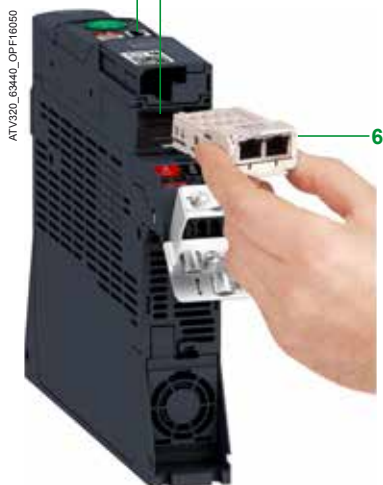
Przykład instalacji modułu komunikacji 6 (widok od spodu) na przeмиenniku w formie książkowym
