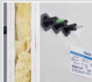
Sąsiadujące ze sobą przepusty można ustawić pionowo albo poziomo przy zachowaniu odległości od środka 50 mm.
