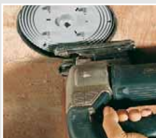
Otwórz część frontową obudowy za pomocą wyrzynarki.
