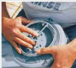
Zatrzasznij pierścień frontowy na obudowie.
