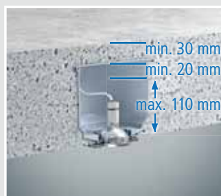
Dobór oprawy oświetleniowej: halogen, wysokie napięcie (230 V) Maks. głębokość montażu: 110 mm (bez pierścienia przedłużającego)
