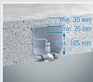
Dobór oprawy oświetleniowej: halogen, niskie napięcie (12 V) Maks. głębokość montażu: 105 mm (bez pierścienia przedłużającego)
