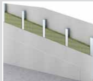
Montaż ściany klasy EI90 na metalowym szkielecie (zgodnie z częścią 4 normy DIN 4102).
