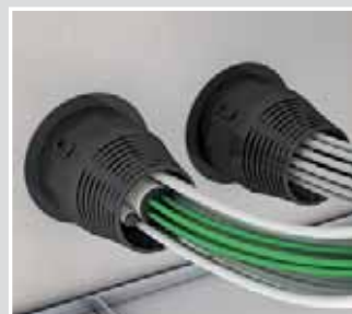
Możliwe jest umieszczenie dwóch przepustów w płaszczyźnie poziomej w odległości 50 mm od siebie.
