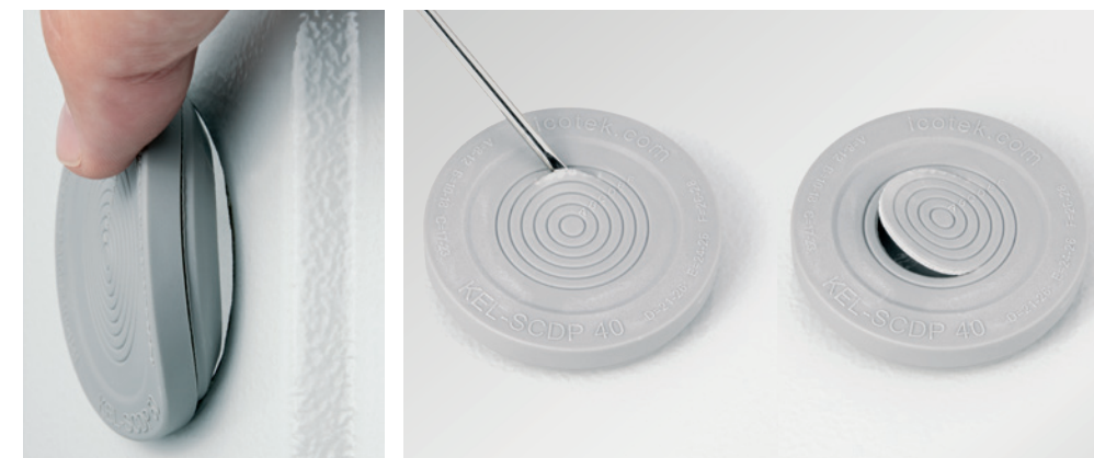
Pojedyncze pierścienie membrany należy oderwać zgodnie do średnicy przewodu. Wystarczy wykonać mały otwór a następnie oderwać cały pierścień.
