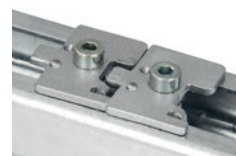
Stopka przykręcana nacięciem zapobiegającym obracaniu na szynę typu C (szerokość ujścia 16 – 17 mm) Op.: 10, Nr kat. 36231
